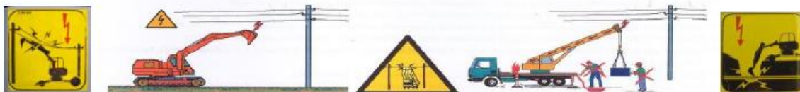
Obr. 13.5: Zakázané činnosti v ochranném pásmu nadzemního el. vedení pod napětím
